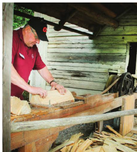
Sören Jonsson visar hur man spåntar spån till tak.
